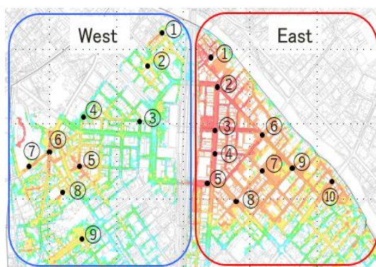
図-2 解析による浸水状況
