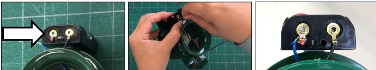
続いて、スイッチのハトメ（金色の輪っか）とその下の穴に赤い線を通し、ねじって固定する。このとき、ハトメに導線の金属の部分が触れるようにしておく。スイッチの反対側にも、黒い線を同じようにつなぐ。
