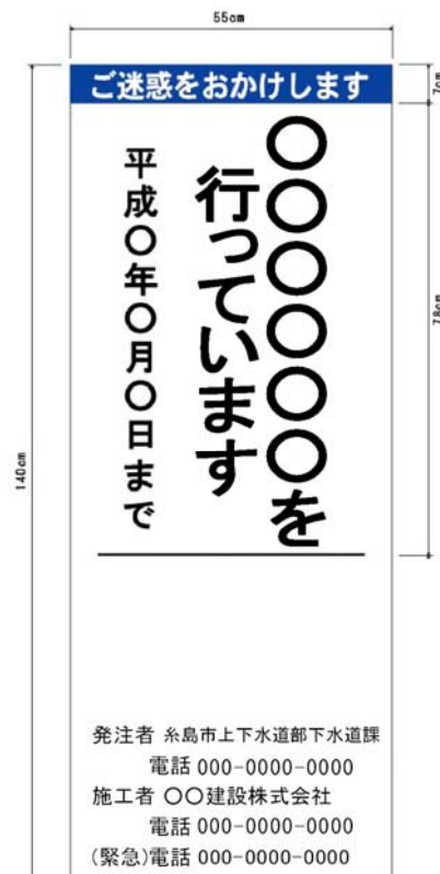
(様式－５) 工事説明看板 (工事内容を説明する看板)
