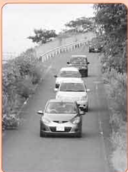
坂道を下るときにエンジンブレーキを使うことで燃費の向上を図れる他、ブレーキパッドの消耗を抑えることができる
