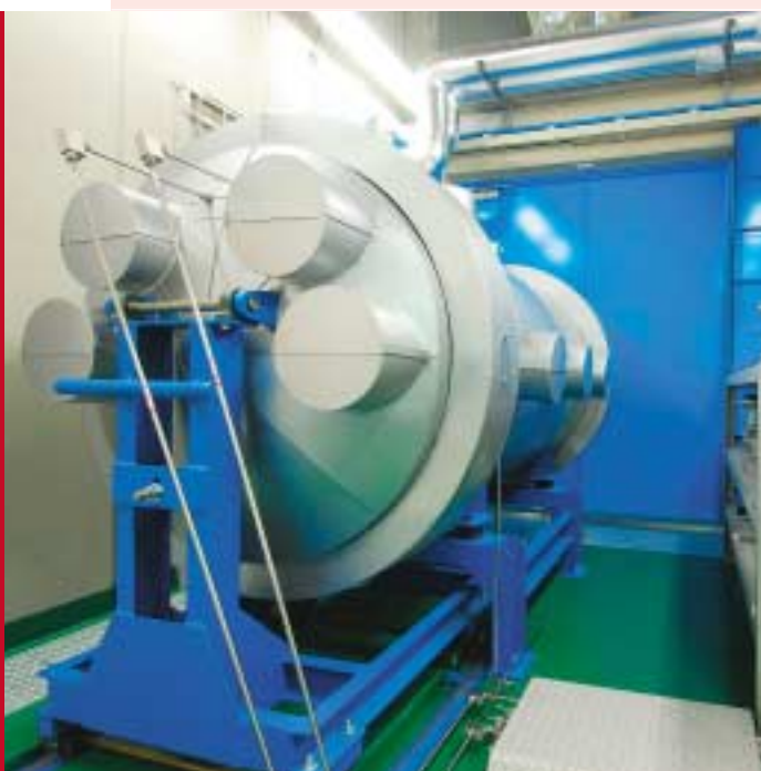
水素エネルギー製品研究試験センターの高圧水素試験室内にある装置。水素製品に高圧を加える試験が行われる
