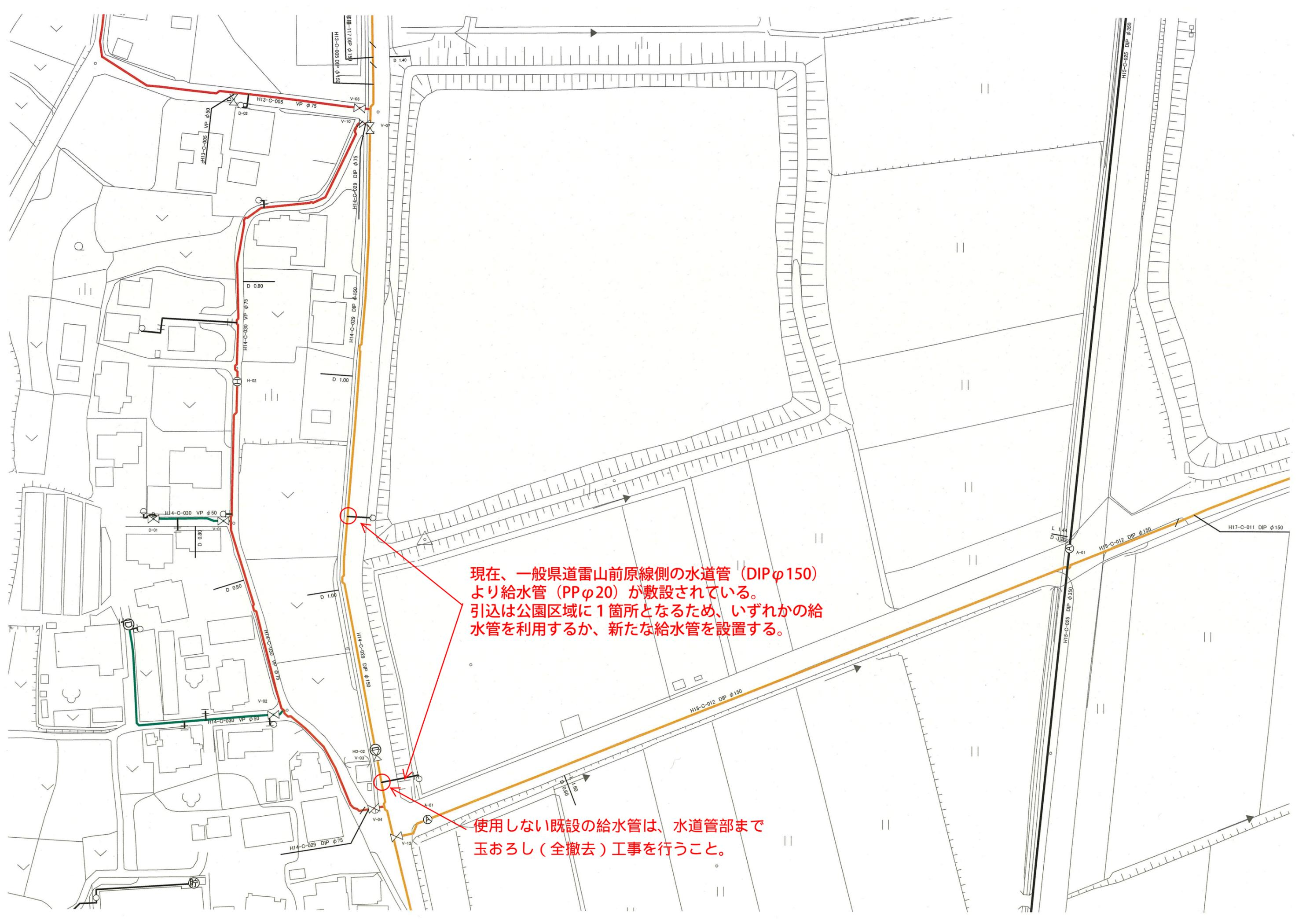
現在、一般県道雷山前原線側の水道管 (DIPφ150) より給水管 (PPφ20) が敷設されている。引込は公園区域に1箇所となるため、いずれかの給水管を利用するか、新たな給水管を設置する。
