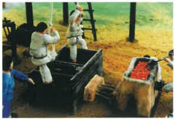
足踏みフィゴと製鉄炉
