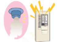
自動火災報知設備
