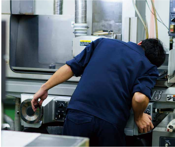
両手で研削機のハンドルを操作して金属の最適な位置を探る
