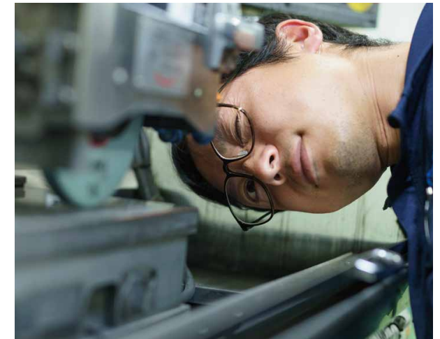
研削機に金属板を設置して、目視で砥石とのわずかなズレを調整する
