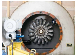
〈ベルトン水車の設計・監理〉 九州大学島谷研究室 (福岡市・糸島市)
