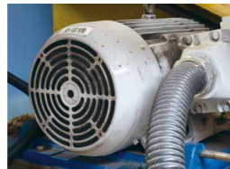
〈ベルトン水車に取り付けた 発電機(IPMモーター)の製作〉 (株)安川電機 (北九州市)
