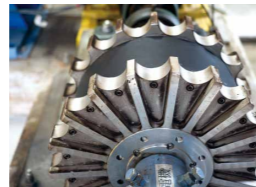
〈クロスフロー水車に取り付けた アウトローター発電機の製作〉 (株)明和製作所 (糸島市)
